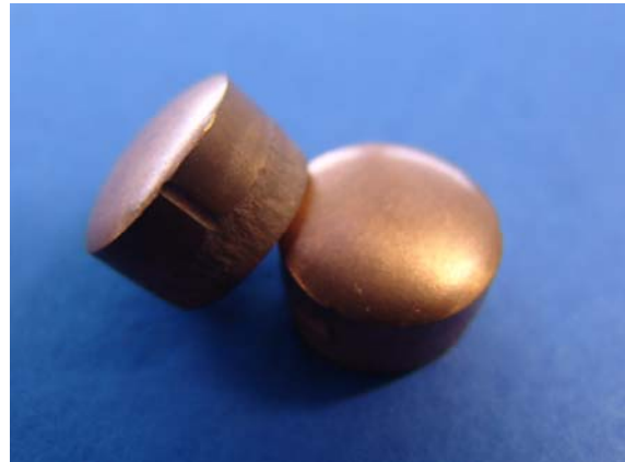
Abbildung 3: Kupferpellets vom Stanzabfall zum Anodenkupfer
